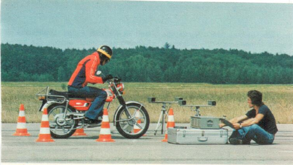
Dreimal durch die Lichtschranke mit Höchstgeschwindigkeit
