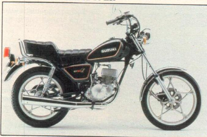
ren gleich. Unterschiede finden sich nur in den Sekundärübersetzungen. GT 80 E und die Enduro TS 80 ER haben am hinteren Kettenblatt 40 und am Ritzel 14 Zähne, der Chopper GT 80 L ist dagegen mit 38/14 Zähnen geringfügig länger übersetzt.
