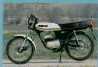
Suzuki: Geringes Gesamtgewicht, gut ausgelegte Lenkgeometrie und günstige Schwerpunktlage machen diese Maschine zur handlichsten des Tests
