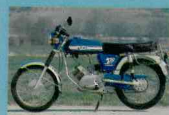
Puch: Eine schlecht zu dosierende vordere Trommelbremse, die zudem noch unrund wurde, mindert die aktive Fahrsicherheit wesentlich
