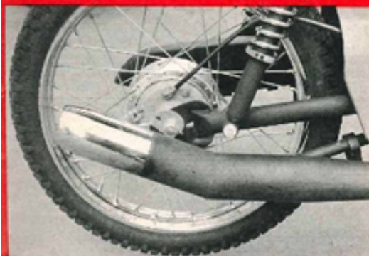
Von links nach rechts: Der neue Kreidler Mustang, wie er sich durch unterschiedliche Radgrößen, das hochgezogene Auspuffendstück, Telegabel, Bremsnaben, Sitzbank und Lenker vom RS-Modell unterscheidet. Lenkerform sowie Sitzbank- und Fußrastenanordnung ergeben echte Enduro-Fahrerposition. Daneben: Der charakteristische Auspufftopf – und die Spezial-Telegabel mit kleiner Bremsnabe.
