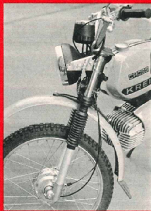
Von links nach rechts: Der neue Kreidler Mustang, wie er sich durch unterschiedliche Radgrößen, das hochgezogene Auspuffendstück, Telegabel, Bremsnaben, Sitzbank und Lenker vom RS-Modell unterscheidet. Lenkerform sowie Sitzbank- und Fußrastenanordnung ergeben echte Enduro-Fahrerposition. Daneben: Der charakteristische Auspufftopf – und die Spezial-Telegabel mit kleiner Bremsnabe.
