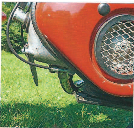
Gebläsegekühlter Motor mit Gummidichtung am Kerzenstecker
