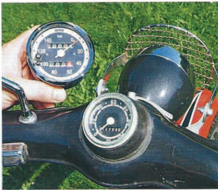
Ein Tachometer mit Tageskilometerzähler soll noch eingebaut werden
